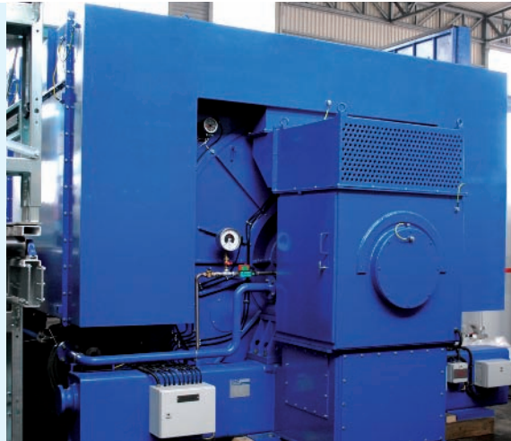
8.350 kW Schleifringläufermotor ASL 1120-08 für ein Sintergebläse in einem Stahlwerk.
