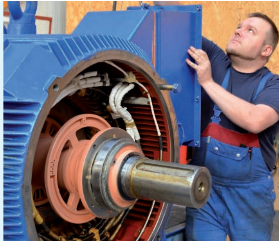
Endmontage 800 kW Käfigläufermotor AKR 450-04.
