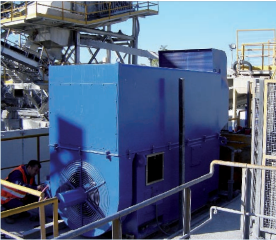
1.950 kW Schleifringläufermotor ASL 560-06 für einen Kohlemühlenantrieb in einem Stahlwerk.
