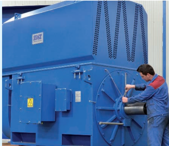
2.500 kW Refinerantrieb AKL 710-06 für die Papierindustrie.
