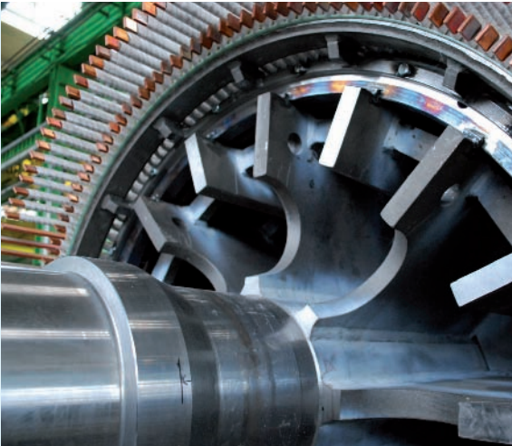
Stegwelle eines 4.000 kW Schleifringläufermotors mit Rotorwicklung.
